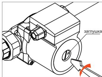
**Внимание!** Если теплоноситель имеет высокую температуру и давление, то при откручивании винта для удаления воздуха может произойти выброс горячего теплоносителя в жидком или газообразном состоянии.
