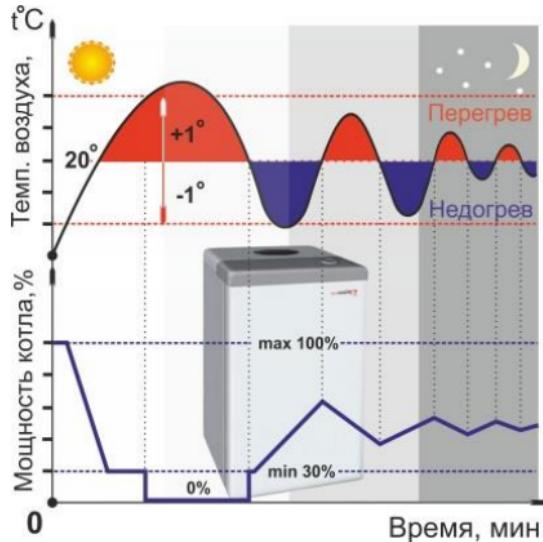
При выходе за пределы гистерезиса, термостат полностью выключает или включает горелку, а вот в промежутке между этими крайними значениями он плавно управляет ее горением. Т.е. процесс чередования периодов недогрева и перегрева будет "затухающим", все время автоматически стремясь к равновесному состоянию, когда котел в любой момент времени отдает в систему отопления ровно столько тепла, сколько требуется для компенсации текущих теплопотерь помещения.
