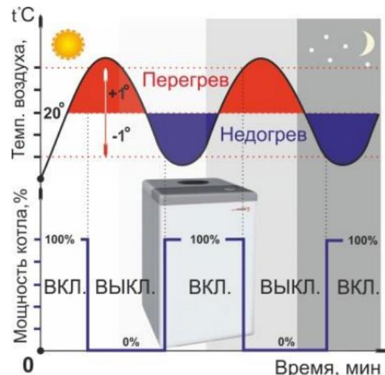
При управлении котлом в релейном режиме термостат или контроллер ZONT измеряет текущую температуру и при отклонении ее значения от заданных параметров, замыкает или размыкает контакты выходного реле, включая или выключая горелку.
