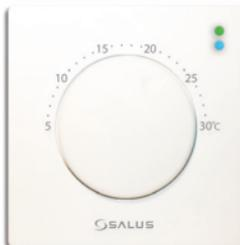
Верхний светодиод горит зеленым цветом, в случае, когда температура падает ниже уровня заданного в режиме защиты от замерзания (5°C). Тогда VS05 дает сигнал для включения функции нагрева.
