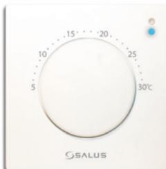
Светодиод горит голубым цветом если регулятор находится в режиме защиты от замерзания. Заводская настройка заданной температуры для защиты это 5°C.
