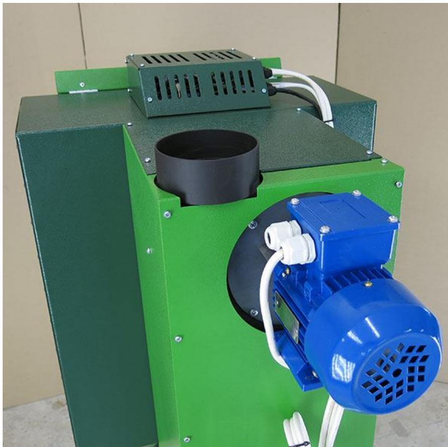
Рис. 7 - Установка дымососа
