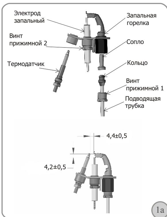
Запальная горелка крепится к основной горелке двумя винтами. Если их вывинтить, то вся запальная горелка будет держаться только на подводящей трубке.
