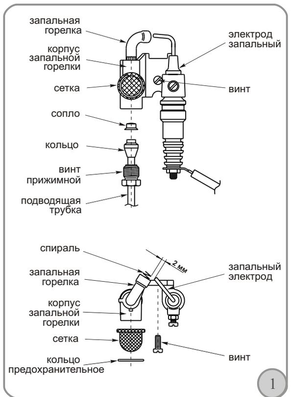
Запальная горелка крепится к основной горелке одним винтом. Если его вывинтить, то вся запальная горелка будет держаться только на подводящей трубке.
