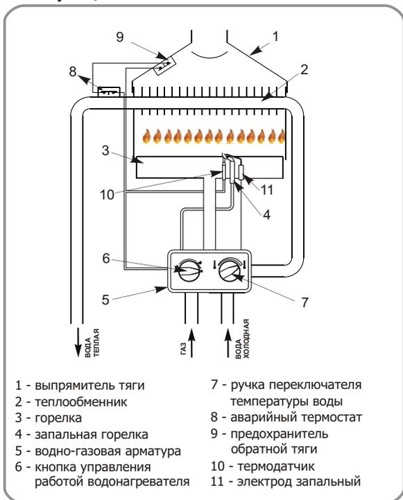
Основной функциональной частью водонагревателя является узел, состоящий из совмещенной компактной универсальной водно-газовой арматуры, газовых основной и запальной горелок. Над основной горелкой расположен теплообменник, обеспечивающий передачу тепла от продуктов сгорания в протекающую воду.
