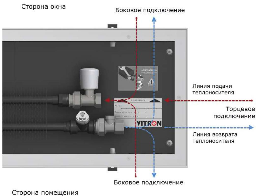
Схема «В». Подающий трубопровод соединить с теплообменником через термостатический клапан. Обратный трубопровод соединить с теплообменником через запорно-регулирующий клапан. На термостатический клапан установить термостатическую головку с выносным датчиком (термостатом) и капиллярной трубкой;
