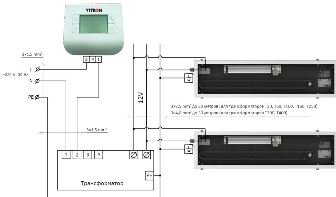
При подключении к трансформаторам ТТ60, ТТ100, ТТ160, ТТ250 использовать провод 3x2,5 мм<sup>2</sup> до 30 метров.
