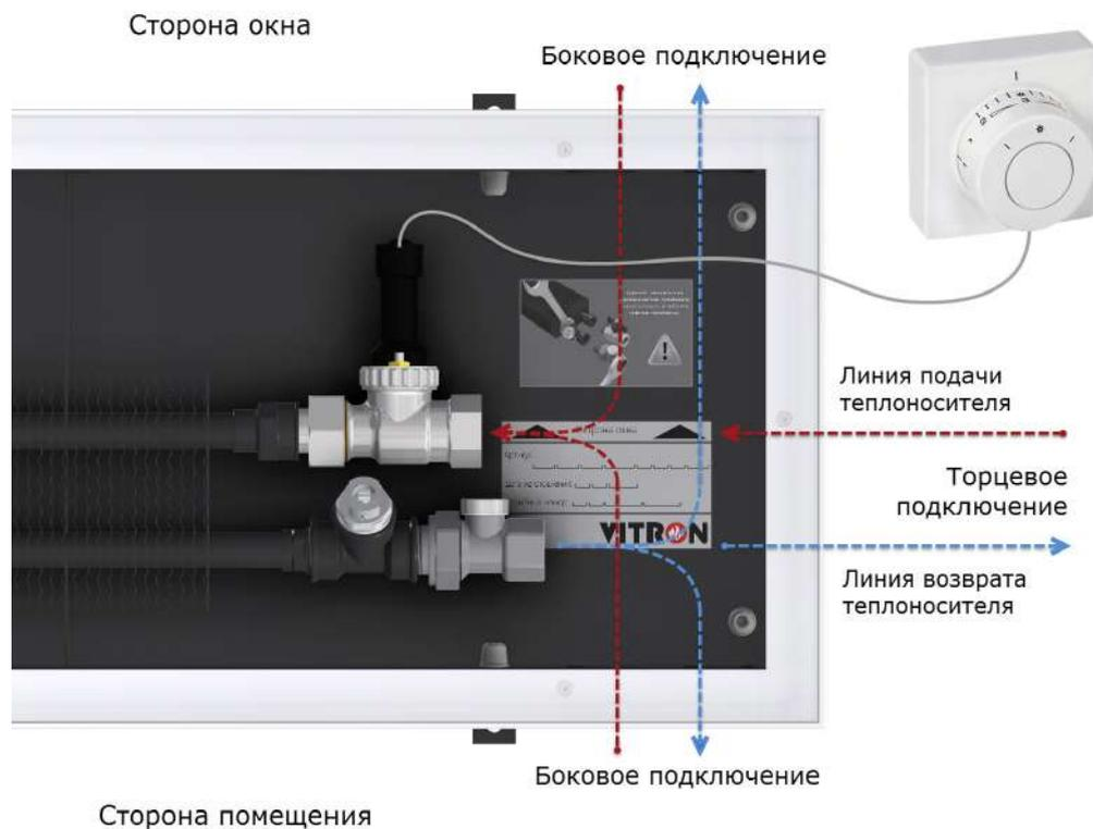
Схема «С» - Подающий трубопровод соединить с теплообменником через термостатический клапан. Обратный трубопровод соединить с теплообменником через запорно-регулирующий клапан. На термостатический клапан установить термоэлектрический двухпозиционный сервопривод;
