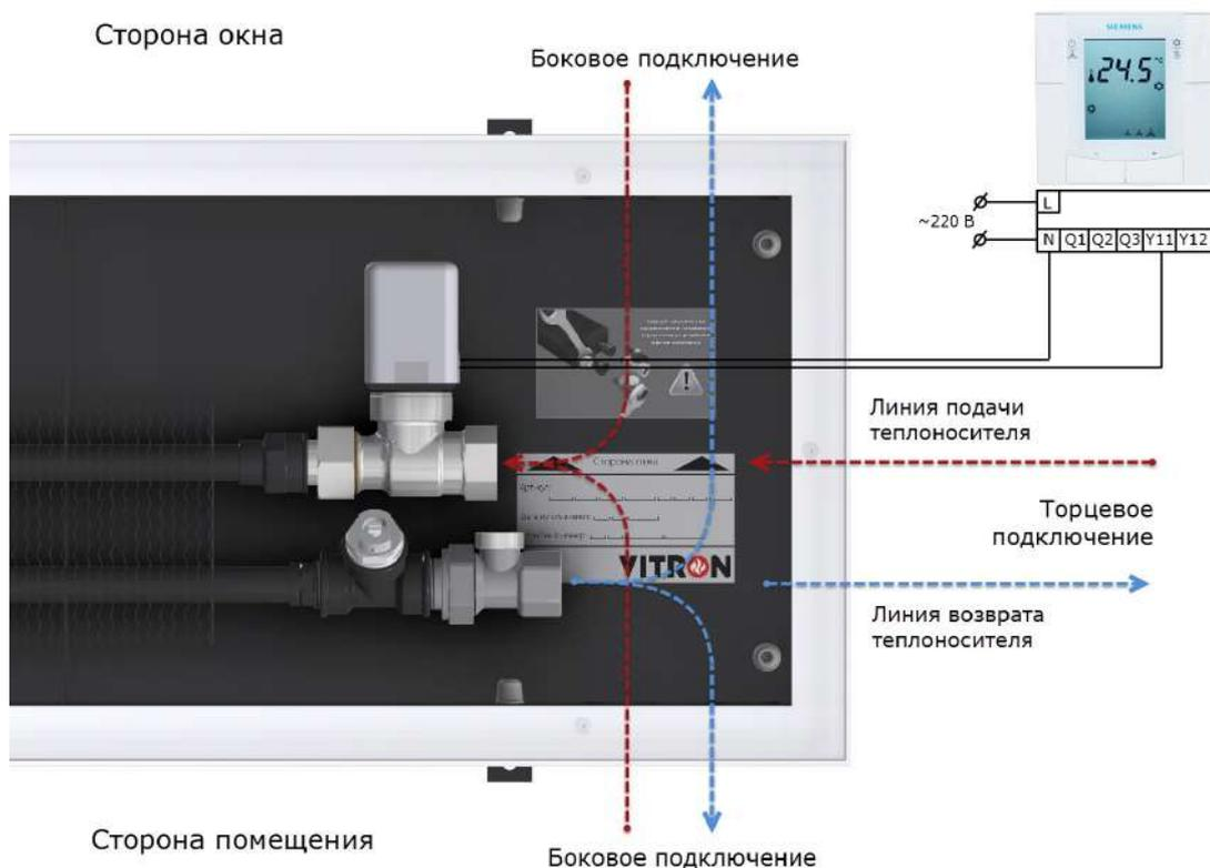
Схема «D» - подающий трубопровод соединить с теплообменником через шаровый кран. Обратный трубопровод соединить с теплообменником через запорно-регулирующий клапан.
