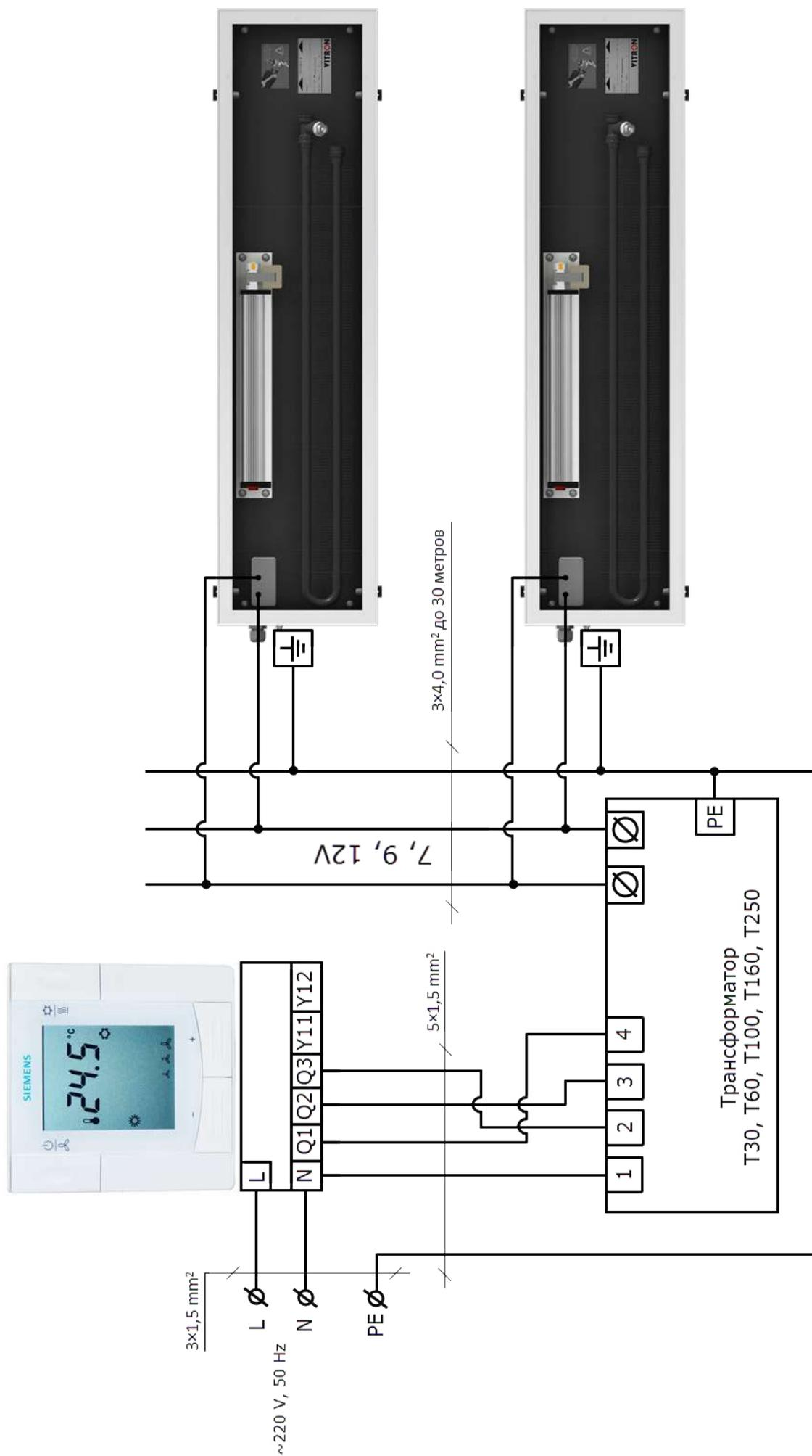
При подключении к трансформаторам ТТ60, ТТ100, ТТ160, ТТ250 использовать провод 3x2,5 мм<sup>2</sup> до 30 метров.
