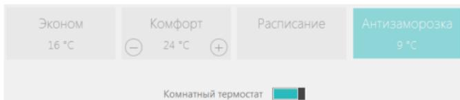
При выключении режима «Комнатный термостат» включается прерванный основной режим работы.
