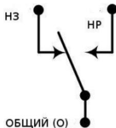
Для управления котлом термостат ZONT имеет на 1, 2 и 3 выходе 6-ти контактного разъема контакты встроенного реле. Контакты имеют обозначение "ОБЩИЙ", "НЗ" и "НР". К котлу надо подключить два из трех контактов.
