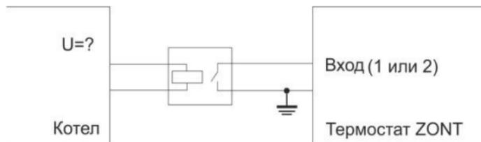
Сигнал «Авария» - напряжение ? В. Необходимо подключение к термостату через соответствующее реле
