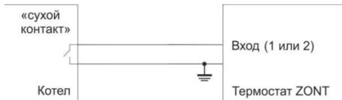
Выходной контакт аварийного разъема подключаемого котла имеет тип «сухой контакт». Допускается прямое подключение к входу термостата.
