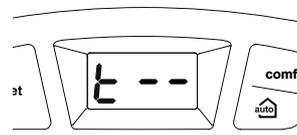
Чтобы перевести котел в режим максимальной мощности в режиме ГВС, нажмите кнопку **+**. Дисплей принимает такой вид:
