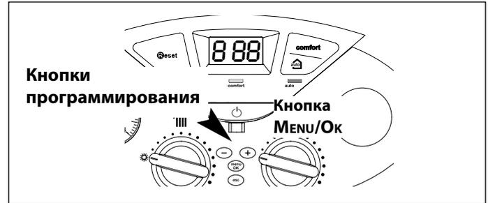
Номера подменю и параметра отображаются на дисплее. Чтобы войти в меню, откройте крышку панели управления и действуйте следующим образом.
