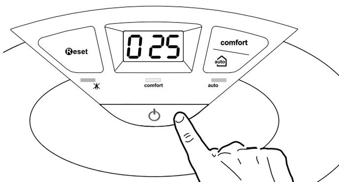
Рабочий режим отображается в виде трёх цифр (см. схему выше).
