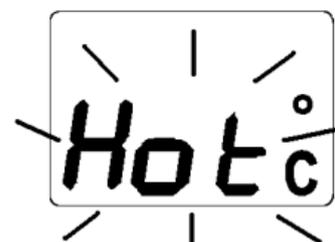
Защита от перегрева отключает силовое реле, тем самым повышая пожарную безопасность устройства и продлевая его ресурс.
