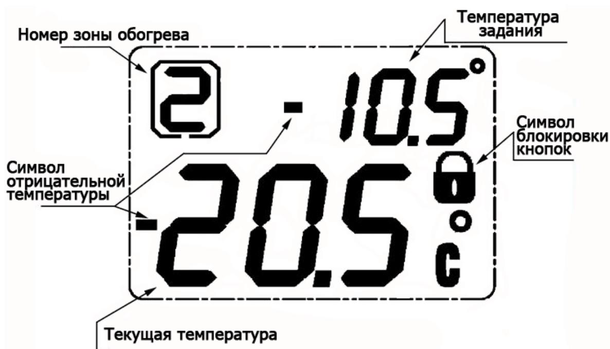
Термостат LTC 440 - термостат с двумя силовыми реле и двумя выносными датчиками температуры. Термостат предназначен для поддержания постоянной комфортной температуры в двух независимых зонах. Температура контролируется в месте расположения выносных датчиков.
