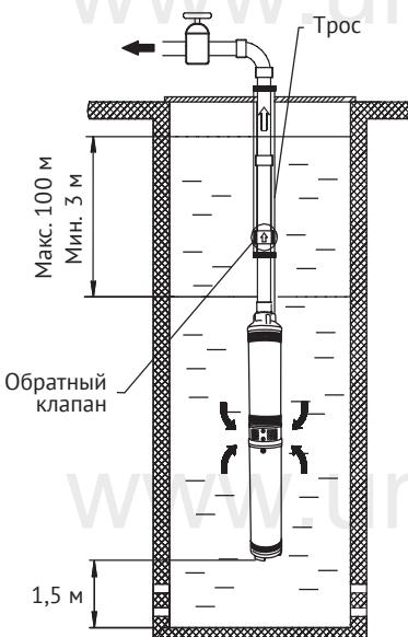
Присоедините напорную магистраль к выходному отверстию насоса (4). В качестве водоподъемных труб можно использовать стальные трубы или трубы из полимерных материалов, выдерживающие давление в 1,5 раза больше, чем максимальное давление, создаваемое насосом. Диаметр напорного трубопровода должен быть не менее диаметра выходного отверстия насоса. При работе в системе автоматического водоснабжения, на выходе насоса
