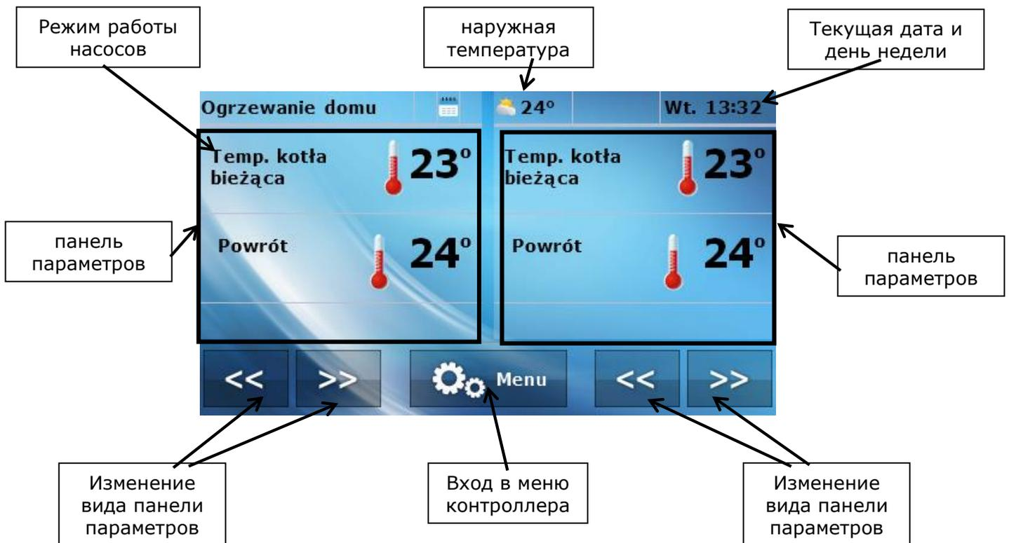
Кнопки изменения вида параметров позволяют просматривать экраны, показывающие текущее состояние подключенных устройств:
