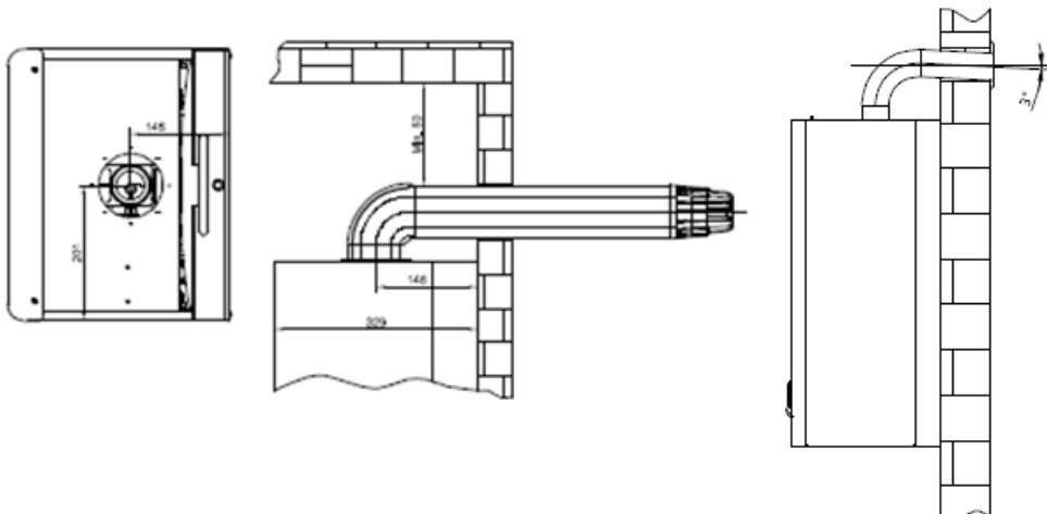
**РАЗМЕРЫ ДИАФРАГМЫ ТРУБЫ ДЫМООТВОДА
