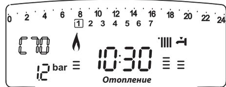
**Регулирование температуры воды в контуре ГВС**
