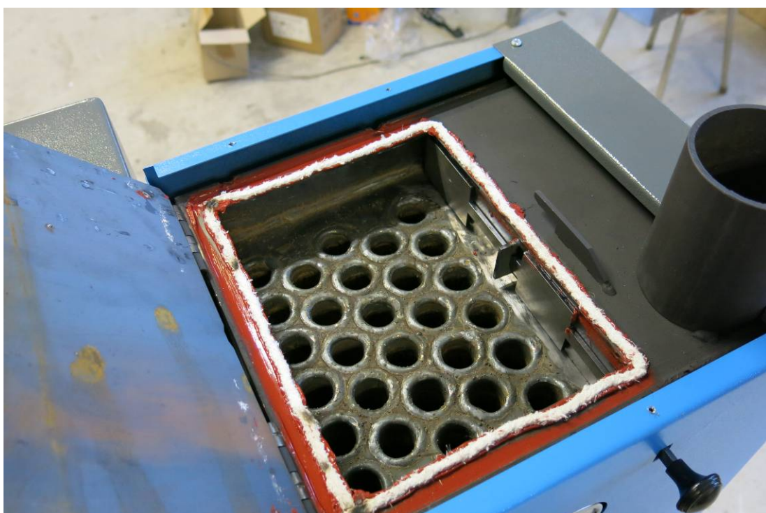
Рис. 8 - Доступ к прочистой крышке теплообменника
