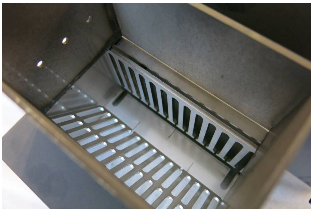
Рис. 21 - Продолжение установка корзины в горелку
