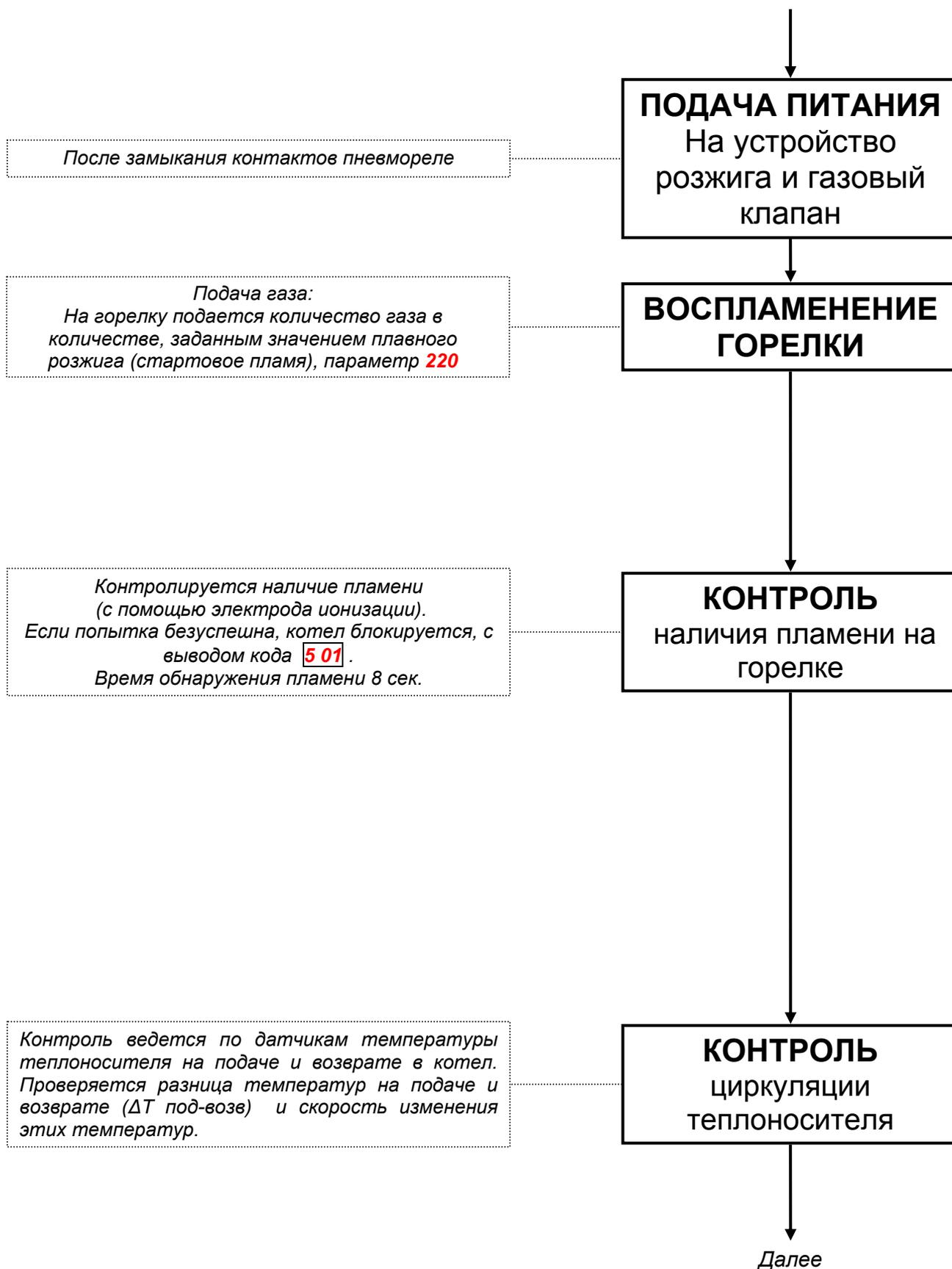
После регистрации наличия пламени на горелке котел производит модуляцию тепловой мощности в зависимости от тепловой нагрузки. Модуляция происходит между макс. тепловой мощностью (регулируется на газовом клапане) и минимальной тепловой мощностью котла (так же регулируется на газовом клапане).
