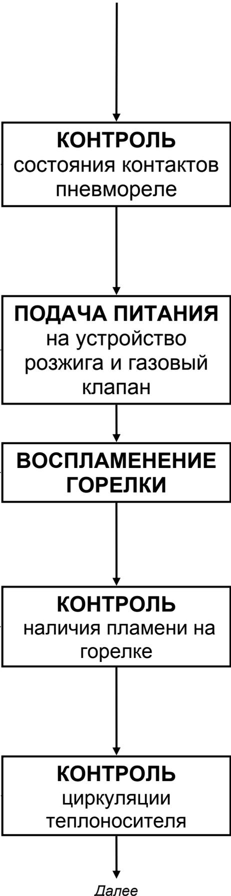
После регистрации наличия пламени на горелке котел производит модуляцию тепловой мощности в зависимости от тепловой нагрузки. Модуляция происходит между макс.тепловой мощностью на отопление (настраивается в меню котла параметром **231**) и минимальной тепловой мощностью котла (регулируется на газовом клапане).
