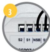
**Клеммы внешнего датчика температуры - S1, S2**
