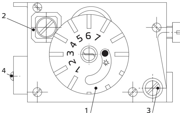
1 — ручка-указатель (кнопка магнитного клапана); 2 — регулировочный винт потока газа; 3 — регулировочный винт запальной (пилотной) горелки; 4 — винт стабилизатора давления
