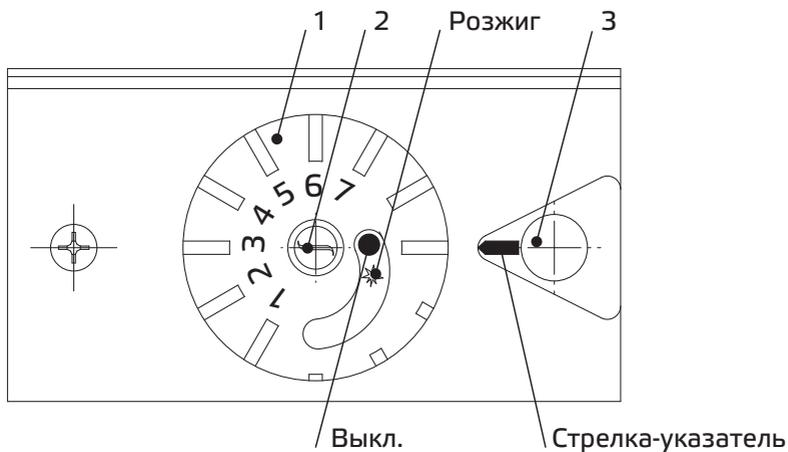
1 — ручка-указатель; 2 — кнопка магнитного клапана; 3 — пьезорозжиг
