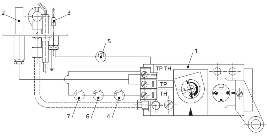
1 — блок газовый; 2 — термогенератор; 3 — термопара; 4 — регулировочный термостат TG 200; 5 — датчик тяги; 6 — предельный термостат TG 400; 7 — комнатный термостат (поставка под заказ)
