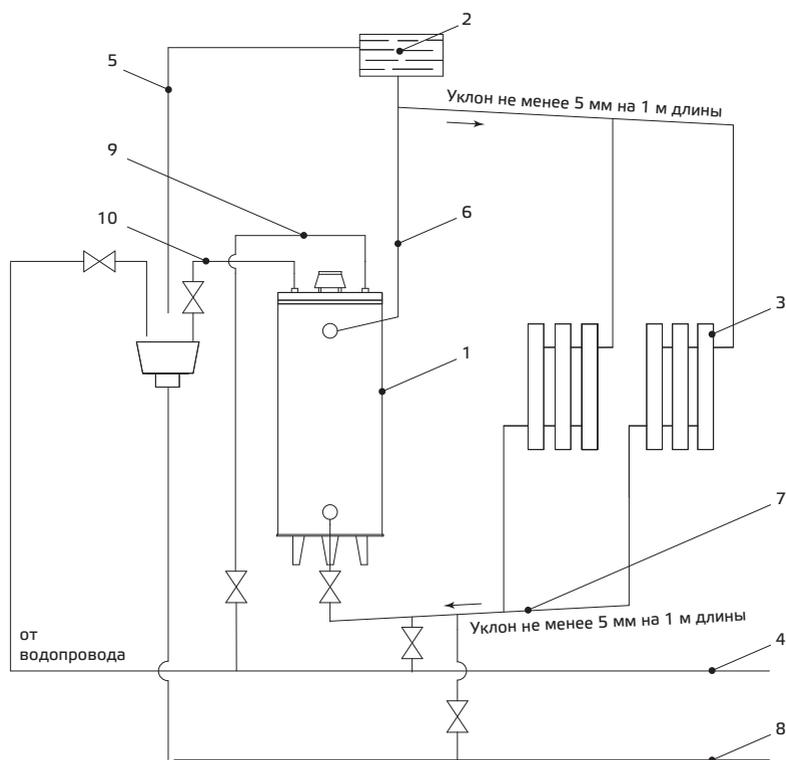
1 — аппарат; 2 — бак расширительный; 3 — радиатор; 4 — водопровод подпиточный; 5 — труба сигнальная; 6 — главный стояк; 7 — трубопровод обратной воды; 8 — сливная магистраль; 9 — холодная вода; 10 — трубопровод горячей воды на бытовые нужды
