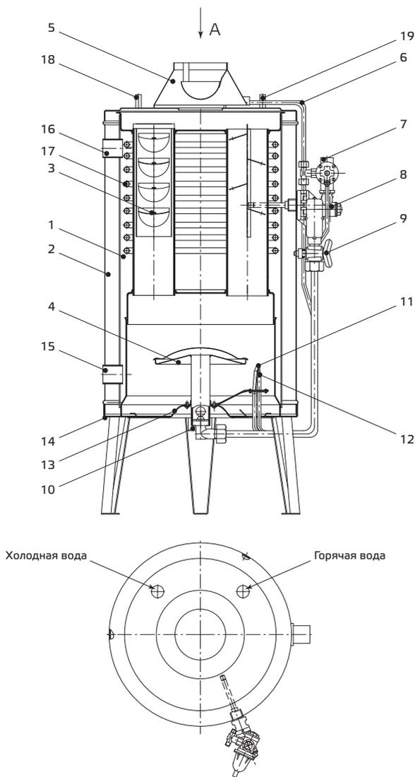
1 — теплообменник; 2 — кожух; 3 — турбулизатор; 4 — устройство газогорелочное; 5 — зонт; 6 — датчик тяги; 7 — магнитный газовый клапан; 8 — терморегулятор; 9 — кран газовый; 10 — заслонка; 11 — горелка запальная; 12 — термопара; 13 — поддон; 14 — основание; 15 — штуцер трубопровода обратного; 16 — штуцер главного стояка (обозн. условно слева); 17 — змеевик; 18 — штуцер входа; 19 — штуцер выхода. Рисунок не определяет конструкцию аппарата
