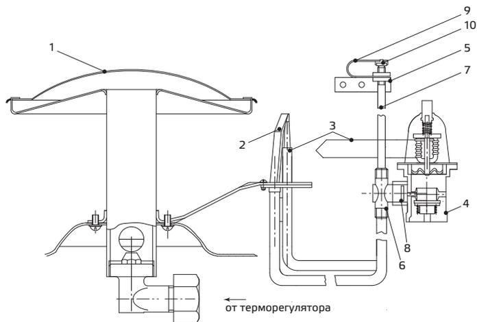
1 — горелка основная; 2 — горелка запальная; 3 — терморепара; 4 — магнитный газовый клапан; 5 — датчик тяги; 6 — тройник; 7 — трубка датчика; 8 — шайба дроссельная; 9 — элемент биметаллический; 10 — клапан
