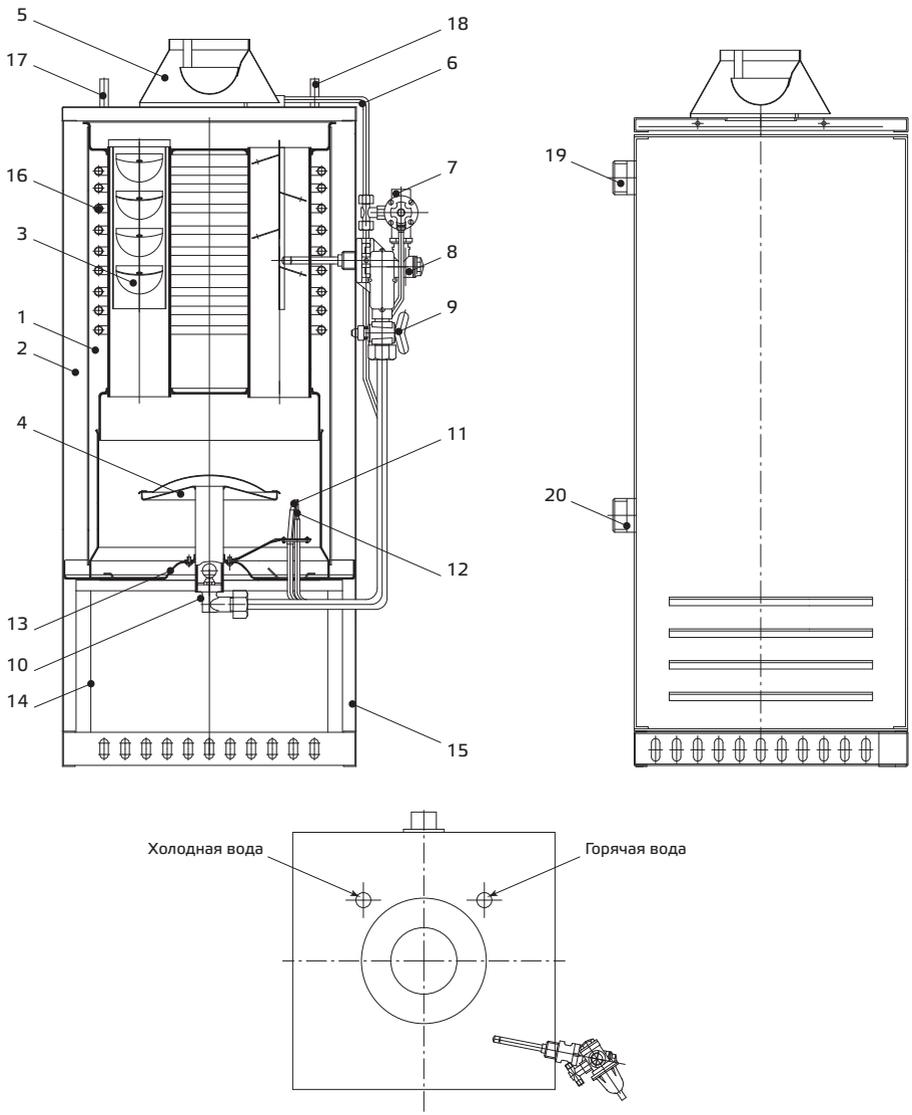
1 — теплообменник; 2 — боковина левая; 3 — турбулизатор; 4 — устройство газогорелочное; 5 — зонт; 6 — датчик тяги; 7 — магнитный газовый клапан; 8 — терморегулятор; 9 — кран газовый; 10 — заслонка; 11 — горелка запальная; 12 — термopара; 13 — поддон; 14 — рама; 15 — боковина правая; 16 — змеевик; 17 — штуцер входа; 18 — штуцер выхода; 19 — штуцер главного стояка; 20 — штуцер трубопровода обратного. Рисунок не определяет конструкцию аппарата
