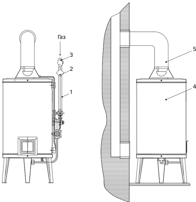
1 — газоподводящая труба; 2 — фильтр; 3 — газовый кран; 4 — аппарат; 5 — дымоотводящая труба
