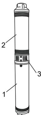
Насос состоит из электродвигателя (1) и гидравлической части (2).
