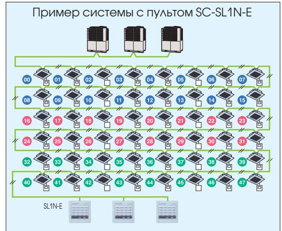
Индикация состояния (неисправен, работает) и одновременный запуск/остановка более одного (до 16) внутренних блоков. Внешние размеры (В x Ш x Г): 120 x 120 x 15 + 62\* мм. \*62 - глубина скрытой в стене части пульта.
