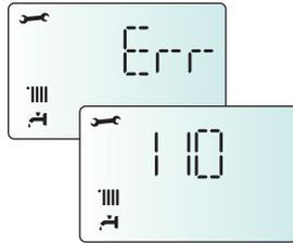
**Защитное отключение из-за низкого давления воды модели FF**
