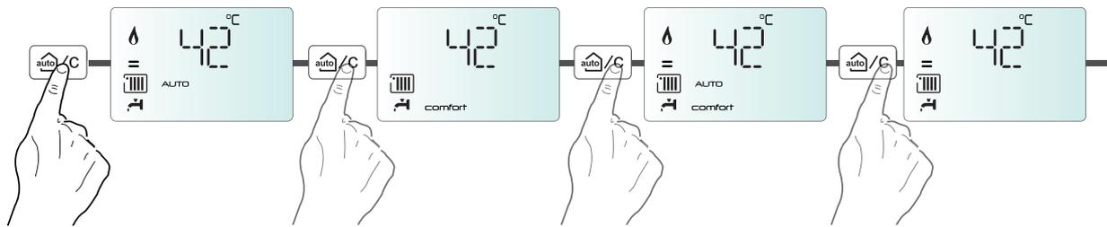
**Функция КОМФОРТ** - включить/отключить внешний бойлер (активно только с комплектом внешнего бойлера SYSTEM PLUS и датчиком NTC)
