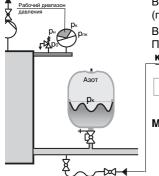
Включить теплогенератор, нагреть воду в системе до максимального значения температуры в подающей (при нагревании воды из нее выделяется растворенный воздух).
