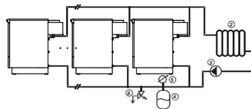
Несколько котлов в каскаде, гидравлической стрелкой, включаемой и отключаемой потребителем.
