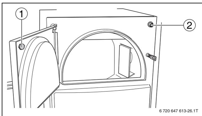
Рис 15 Контактный выключатель двери
