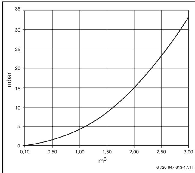
Рис 5 Гидравлическое сопротивление в зависимости от объёмного расхода
