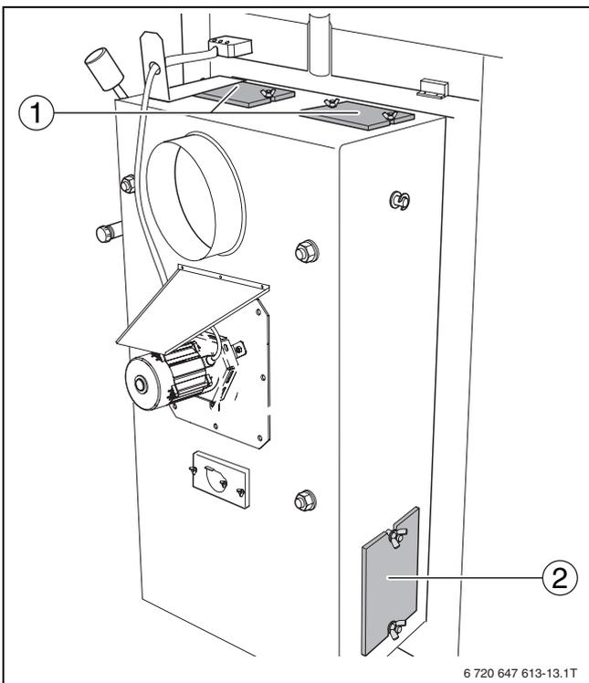
Рис 26 Люки для чистки коллектора дымовых газов
