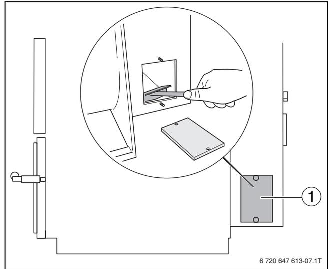
Рис 27 Боковой люк для чистки коллектора дымовых газов
