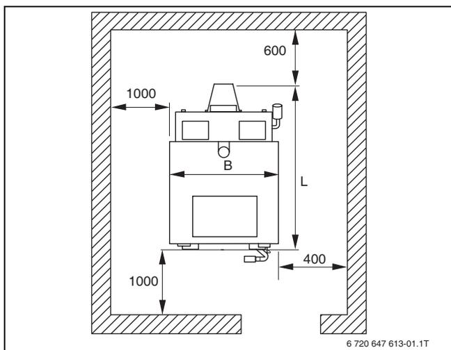
Рис 6 Расстояния от стен в помещении установки оборудования
