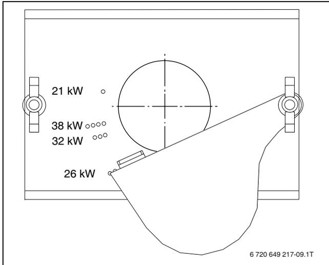
Рис 12 Регулировка заслонки вторичного воздуха по мощности котла
