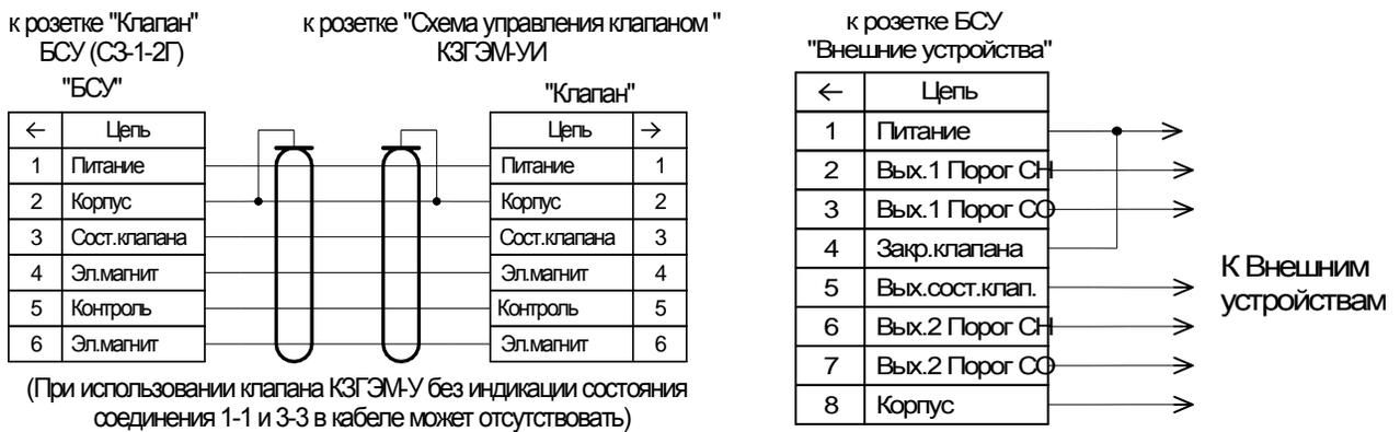
Рисунок Б.3 – Схема кабеля для подключения клапана КЗГЭМ-У
