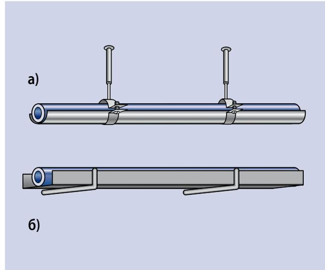
Компенсация линейного расширения чаще всего производится при помощи изменения трассы трубопровода или использования П-образных компенсаторов или компенсационных петель. Компенсация может быть решена с помощью подвесок или горизонтальных консольных опор. При варианте **а)** трубопровод изолируется (см. главу 10. раздел 10.7.) вместе с желобами, при варианте **б)** в желоба укладывается уже изолированный трубопровод.
