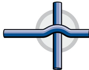
Пересечение трубопровода производится при помощи специальной детали – перекрещивания.
