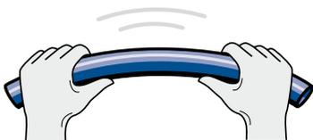
Минимальная температура для сгибания полипропиленовых труб без нагрева +15 °C (монтаж теплого пола). Минимальный радиус изгиба трубы диаметром 16-32 мм равен 8-ми диаметрам изгибаемой трубы.
