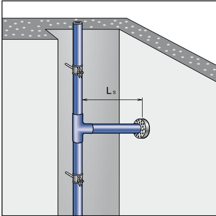
– дополнительного расстояния между стояком и отверстием в стене
