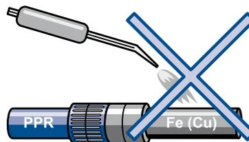
Находящийся за комбинированным фитингом металлический трубопровод нельзя соединять сваркой или пайкой вблизи фитинга во избежание переноса тепла на фитинг.
