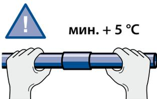
Минимальная температура при монтаже полипропиленовых труб +5 °C. При более низких температурах трудно обеспечить условия для качественного соединения.
