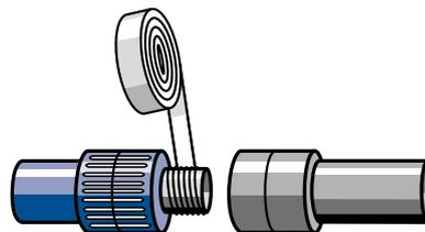
Для резьбовых соединений необходимо использовать имеющиеся фитинги с резьбой. Нарезать резьбу на полипропиленовых деталях запрещается. Для уплотнения резьбовых соединений применяется тефлоновая лента или специальные уплотняющие материалы (не рекомендуется применять сантехнический лен и паклю).
