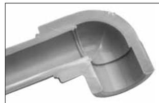
Соединение полипропиленовых деталей производится при помощи полифузной, электромуфтовой или стыковой сварки. При сварке возникает гомогенный шов высокого качества. При сварке необходимо точно соблюдать правила монтажа и использовать специальные качественные инструменты. Детали системы Ekoplastik PPR не рекомендуется сваривать с деталями других производителей.
