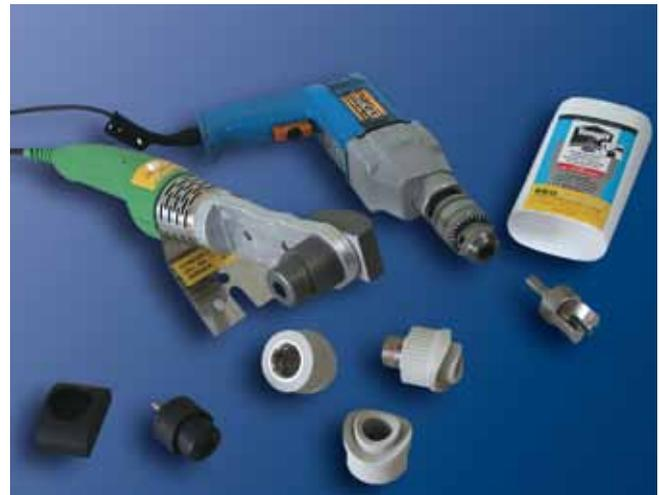
**Необходимое оборудование:** специальная фреза, дрель, тряпка или салфетка для обезжиривания, специальная насадка, вварное седло, плоский сварочный аппарат, нож для снятия фаски у армированных труб.
