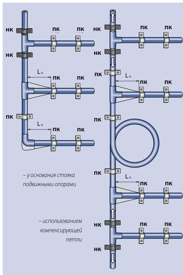
Если возникает необходимость разделить стояк на несколько компенсационных участков, то это делается при помощи установки неподвижных опор. На стояке неподвижная опора устанавливается под и над тройником у ответвления или у муфты в месте соединения труб, что одновременно предотвращает оседание стояка.
