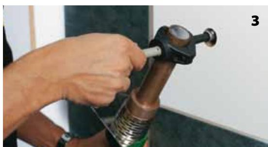
С началом нагрева ремонтного стержня медленно без поворота, вставить штырь насадки в подготовленное отверстие. Время нагрева – 5 сек.
