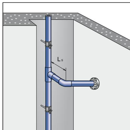
– монтажа компенсирующего плеча
