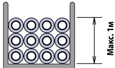
Полипропиленовые трубы следует укладывать на стеллажи или иные поверхности всей плоскостью (необходимо избегать прогиба труб). Пластиковые фитинги хранятся в мешках, коробках, контейнерах, ящиках и т.п. При хранении труб в пластиковых рукавах и фасонных изделий в пластиковых мешках высота штабеля не должна превышать 1 метра. Различные виды труб и фитингов необходимо хранить отдельно друг от друга. Первыми нужно вывозить со склада детали, хранившиеся наиболее долго.
