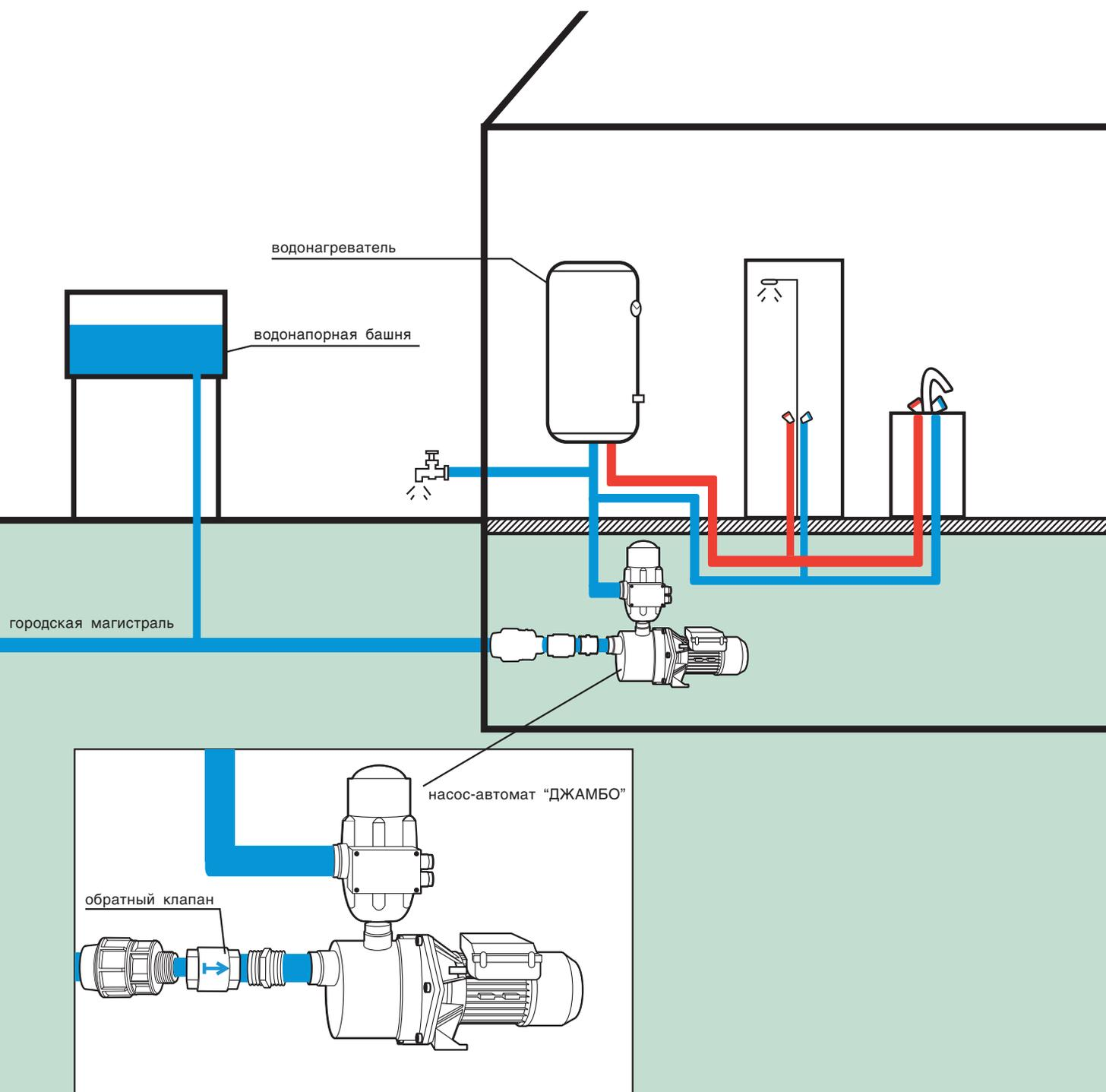
2. Схема подключения поверхностного насоса-автомата «Джамбо» к открытому источнику:
