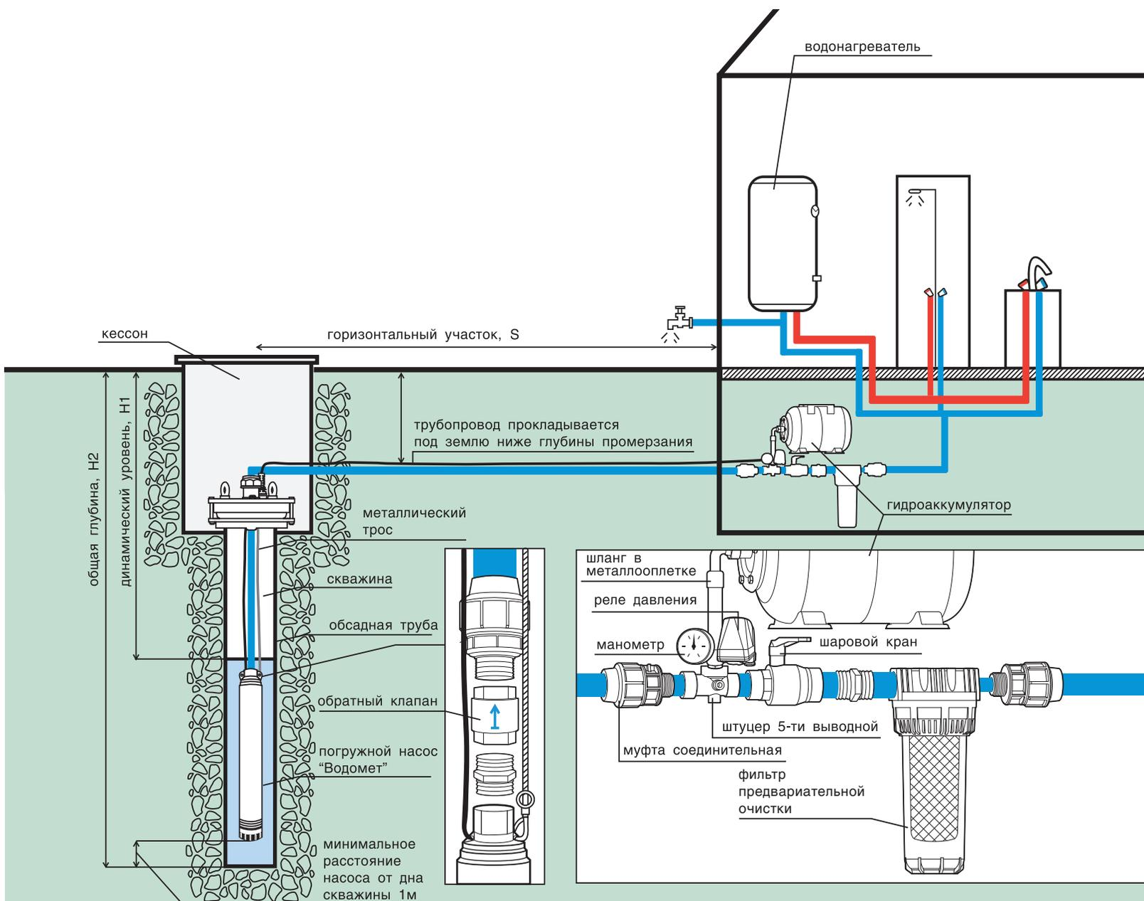
2. Схема подключения погружного многоступенчатого центробежного насоса «Водомёт» с индексом А:
