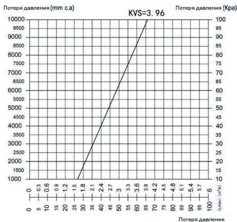
Расчет пропускной способности для групп, оборудованных насосом, рассчитывается отдельно с учетом характеристик насоса. Остаточный напор насоса должен быть достаточен для нормальной циркуляции теплоносителя в общей системе, в противном случае необходимо заменить насос на более подходящий по характеристикам, либо заменить группу с более подходящим размером.
