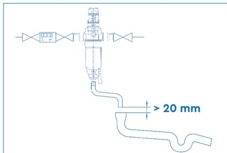
Отвести шланг слива промывочной воды к канализации, следить за тем, чтобы не было обратного подпора, или установить под фильтром приемную емкость (прибл. на 10 литров). В соответствии с нормами DIN EN 1988-200 шланг промывочной воды следует закрепить на расстоянии мин. 20 мм над зеркалом стоков (свободный сток).
