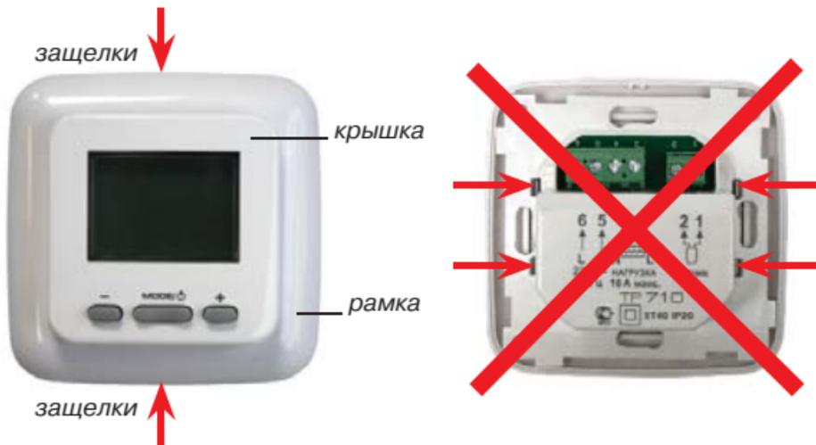
Рис. 11 Снятие крышки прибора
