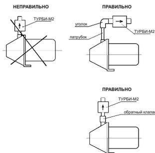
**⚠ ВНИМАНИЕ!** Не допускается вертикальная установка блока непосредственно на выходной патрубок поверхностного насоса без обратного клапана.
