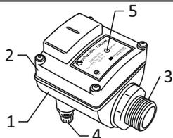
Блок управления ТУРБИ-М2 состоит из герметичного пластикового корпуса - (1) и верхней крышки с резиновой прокладкой (2). На корпусе расположены два присоединительных резьбовых патрубка с наружной резьбой 1" – (3), а также два кабельных ввода – (4). На верхней крышке
