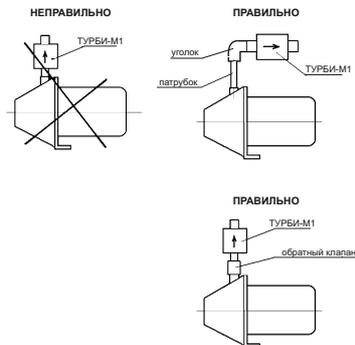
**⚠ ВНИМАНИЕ!** Не допускается вертикальная установка блока непосредственно на выходной патрубок поверхностного насоса без обратного клапана.
