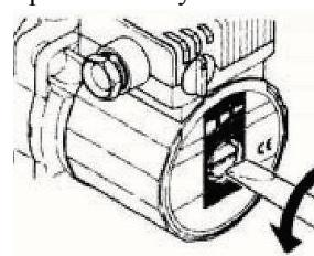
6.4. На работающем насосе необходимо отвинтить пробку для удаления воздуха из корпуса насоса. После выпуска воздуха, пробку следует установить на место.
