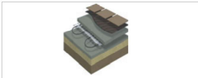
При этом греющие элементы/провода укладываются в стяжку с соответствующей толщиной. В зависимости от толщины стяжки зависит время инерции отдачи тепла. Поэтому верхний слой стяжки над нагревательным элементом может рассматриваться в качестве теплоаккумулирующей среды накопления.
